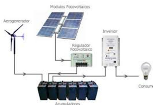
Imatge 13. Esquema sistema híbrid Solar FV-eòlic
